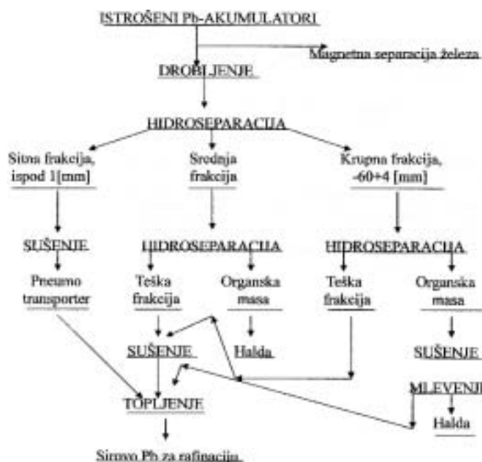
Slika br.2 Osnovna tehnološka šema prerade Pb-akumulatora hidroseparacijom
