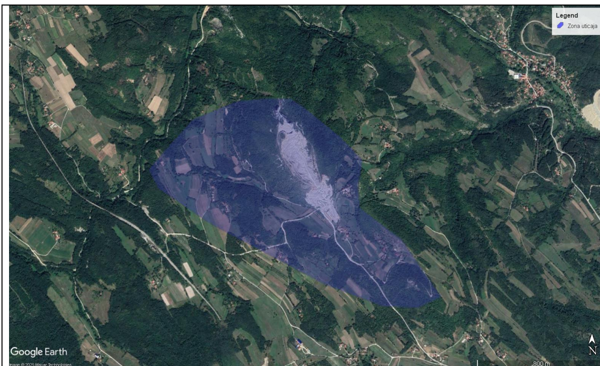
Слика 4. Зона утицаја од прашине са површинског копа и дробиличног постројења рудника кречњака Кривељски камен
